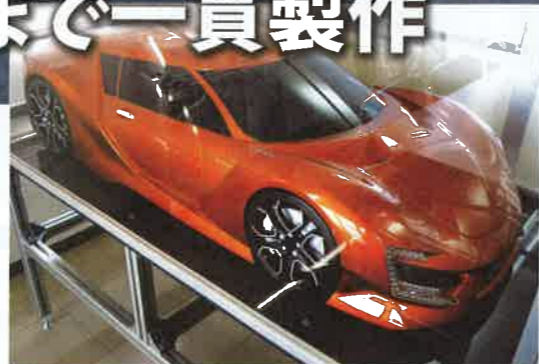
型には、デザインを検討するための「スケールモデル」（写真）、また、設備機械に載せて「量産型」として使う型などがある。同社では、これらの型と設備機械を一貫製作する
